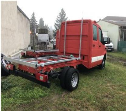
Beim Fahrgestell handelt es sich um einen Mercedes Sprinter 519 Cdi 4x4 mit 190 PS, Allradantrieb, Automatikgetriebe sowie einem höchstzulässigen Gesamtgewicht von 5 Tonnen. Mit dem seit einigen Jahren gültigen 5,5t-Feuerwehrführerschein ist es somit auch unseren Mitgliedern ohne LKW-Führerschein möglich, nach interner Schulung und Prüfung, dieses Fahrzeug zu lenken.
